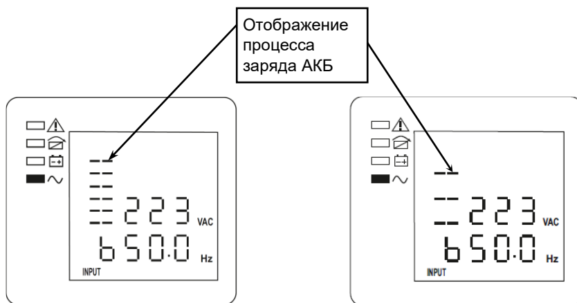
Рисунок 21 — ЖК-дисплей: форсированный (ускоренный) заряд АКБ
